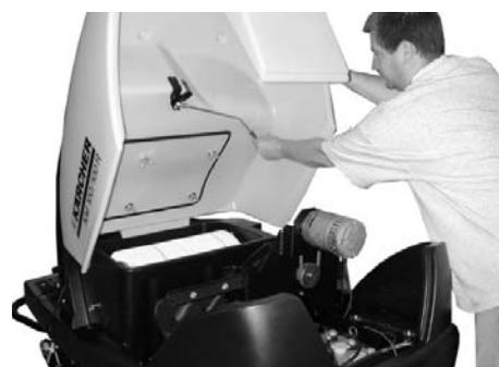
→ Вытянуть фиксирующий рычаг из держателя.
